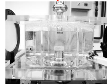
Optisch zugänglicher Behälter zur Visualisierung des Dampfblasenfeldes
