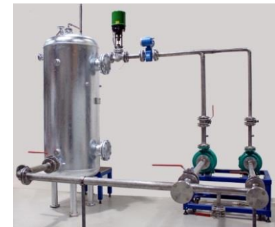
Pumpenprüfstand für NPSH-Messungen
