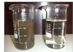
Belebtschlamm und Filtrat der abschließenden Reinigungsstufe
