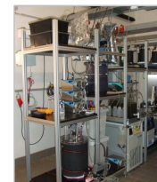
Aufbau der Versuchsanlage: Aerobe (MBR) und anaerobe Abwasserbehandlung, mikrobielle Brennstoffzellen (MFC)
